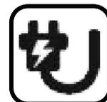
**Авторестарт** - автоматически возобновляет работу кондиционера в установленном режиме после возобновления подачи электроэнергии.
