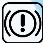
**Индикатор ошибок** - индикация неисправности наружного блока (красный цвет), при исправной работе (зеленый цвет).
