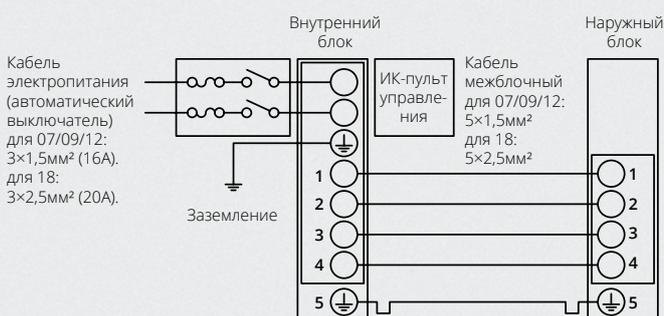
Схема подключения Smart (LK700) On-Off (24/30/36)
